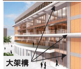
タイプI 2層分のRC造大架構の中に木造架構を設置
