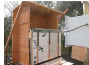
通気構法の外壁への送風散水試験
