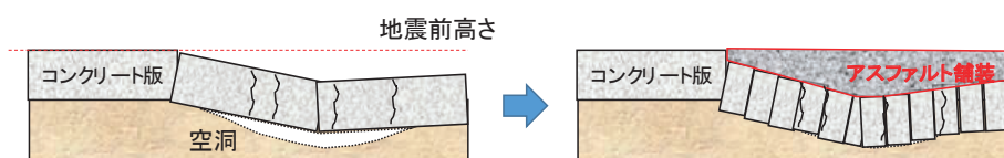
アスファルト混合物によるコンクリート舗装の早期復旧イメージ
