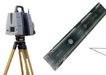
図-2 点群データを用いた出来形管理
