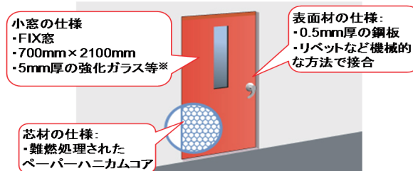
図-2 準堅穴区画に用いる防火設備(10分遮炎性)
