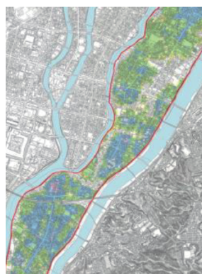
図-2 モデル地区下水道からの氾濫による浸水想定例 (時間雨量約80mm：著名水害降雨)
