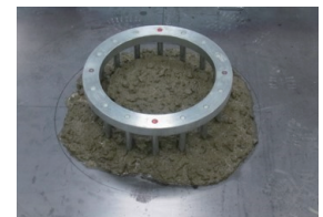
写真2 (左)スランプフロー試験(右)J-Ring試験
