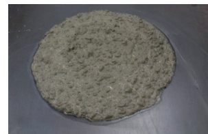
写真2 (左)スランプフロー試験(右)J-Ring試験
