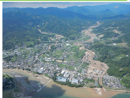
上流の土砂生産と下流への土砂流出
