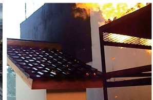
瓦屋根における飛び火実験
