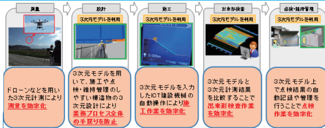
建設生産プロセスにおける3次元モデルの流通と活用効果の例
