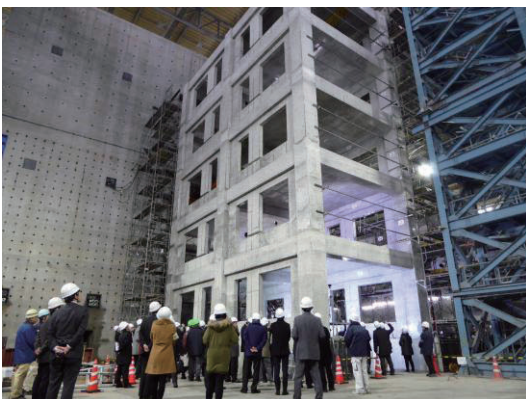
写真1 実大5層建築物の損傷実験
