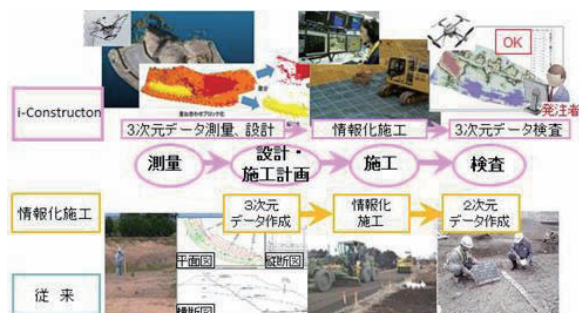
図-2 ICTの活用による土工全体の生産性向上
