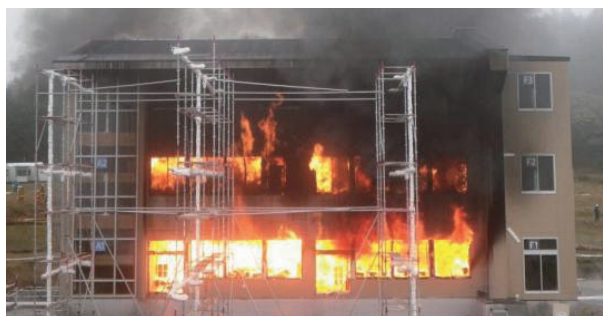
写真2 木造3階建て学校のための基準化を想定した仕様の妥当性検証のための実大火災実験
