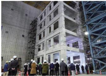
実大5階建て建築物の載荷実験
