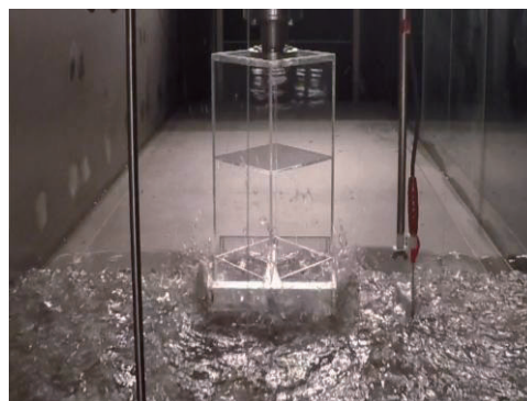
写真2 低抗力型建築物モデルの水理実験
