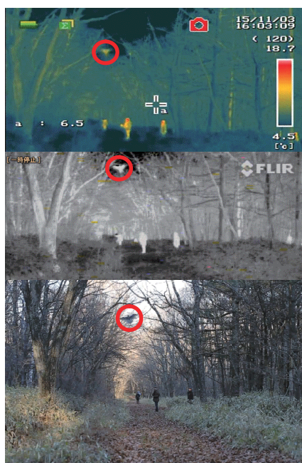
図1 木の枝に止まるオオタカを撮影した結果。上から順に、赤外線サーモカメラ（一般用）、赤外線サーモカメラ（動物調査用）、ビデオカメラの映像。オオタカまでの距離は、約50mある。
