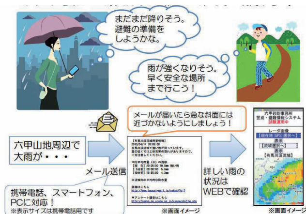
図 XRAIN雨量データを用いたアラートメール配信 (近畿地方整備局六甲砂防事務所HPより)
