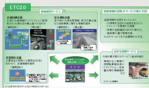
図-1 ETC2.0サービスの概要
