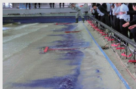
図-1 海岸侵食対策工の検討で活躍する造波施設
