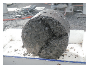
(a) たわみ量測定 (b) コア採取・分析 写真-2 アスファルト舗装の構造調査
