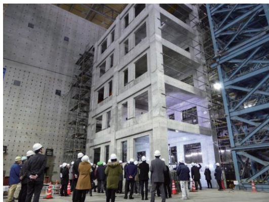
写真1 実大5層建築物の損傷実験
