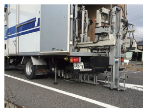
(a) たわみ量測定 (b) コア採取・分析 写真-2 アスファルト舗装の構造調査
