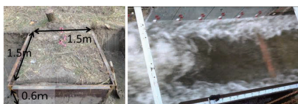
写真2 （左）供試体採取時と（右）通水実験時
