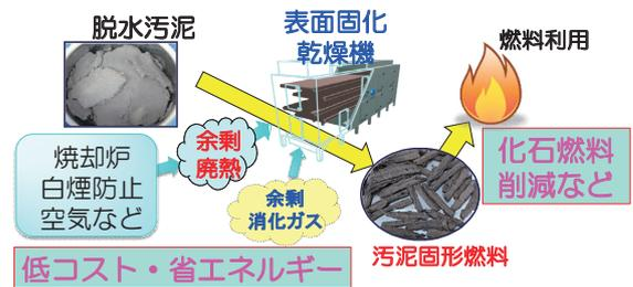
図-1 廃熱利用型固形燃料化技術
