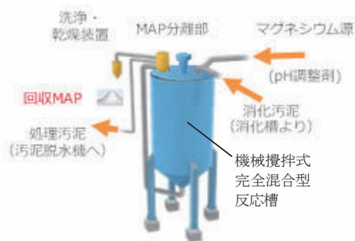
図-3 消化汚泥からのリン除去・回収技術
