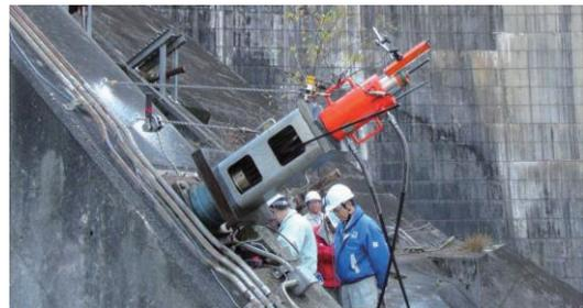
図-2 試行点検で実施したリフトオフ試験の状況
