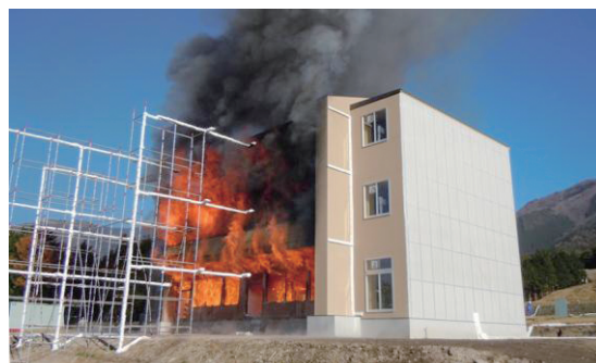
写真 2階に延焼した点火後137分時点の様子
