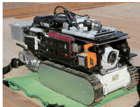
写真 木造建築物の予防保全的管理のための 床下劣化診断装置（遠隔操作回転機能付き）
