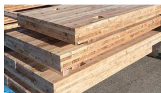
写真1 クロス・ラミネイティド・ティンバー (CLT) パネル
