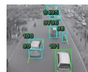
図-2 画像処理による交通量計測
