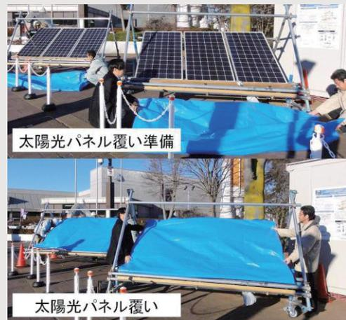
写真1 太陽光パネルの発電量を変化させる様子
