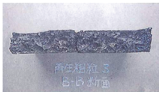
写真 水浸ホイールトラッキング試験後の再生粗粒度アスファルト混合物
