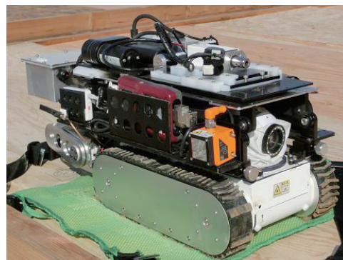
写真 木造建築物の予防保全的管理のための 床下劣化診断装置（遠隔操作回転機能付き）
