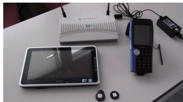
写真1 基礎アプリケーションの構成機器
