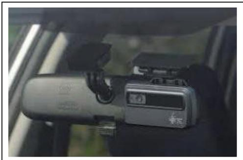
写真1 バックミラー部へのカメラ装着例
