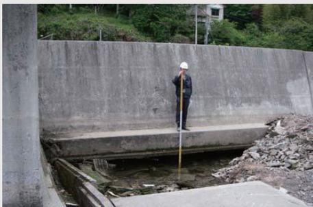
写真 現地調査状況 (基礎部の吸出し)
