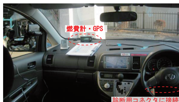
写真1 燃費計の車両搭載状況
