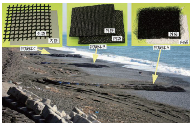
図-2 試験体の設置状況と各素材の構成
