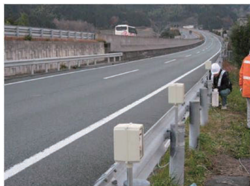
写真1 可搬式トラフィックカウンターによる交通量調査
