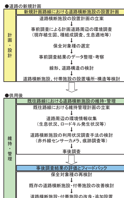
図-1 道路横断施設設置計画のフロー
