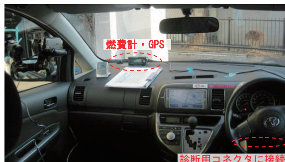
写真1 燃費計の車両搭載状況
