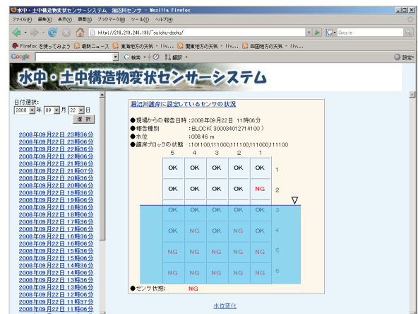
図-1 変状検知センサーのWeb画面 3)
