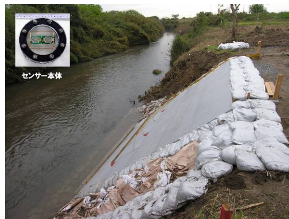
写真-1 変状検知センサーの現地試験
