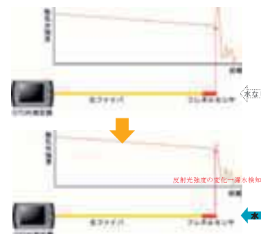
図-2 フレネル反射型光ファイバの計測原理
