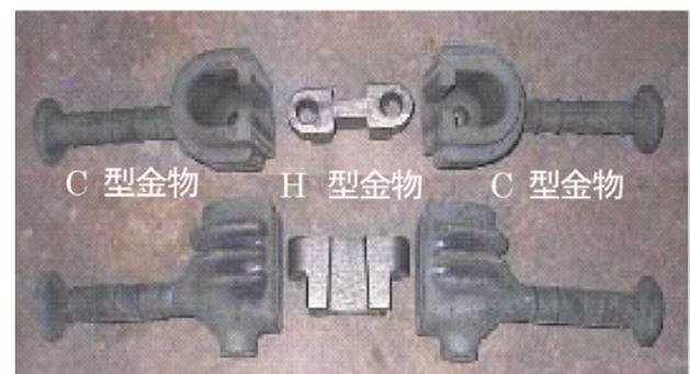
写真-2 コッター式継手
