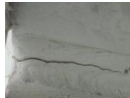
写真 - 1 鋼部材の疲労亀裂
