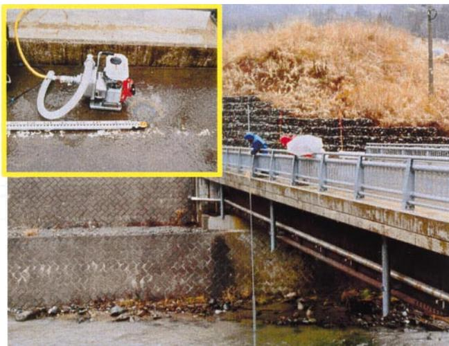
写真-4 自給式ポンプ採水装置
