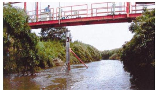
写真-5 溜沼洪水観測施設<sup>4)</sup> 河川研究室提供
