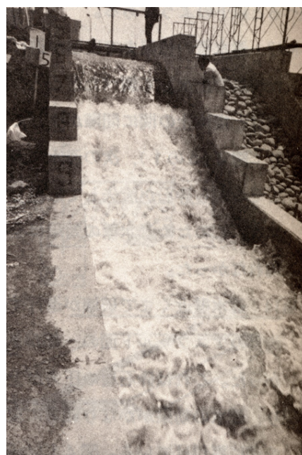
写真-2 越水堤防実験 (天端アスファルト+蛇籠)
