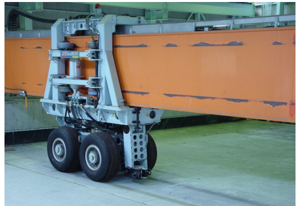
写真－2 PPC版舗装の試験施工と走行載荷試験装置
