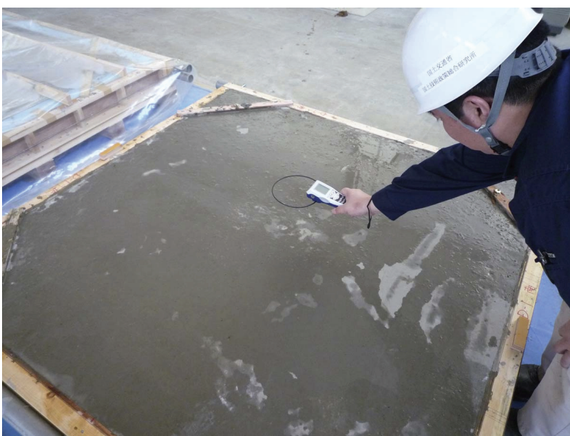
コンクリート中に埋め込んだICタグの情報をコンクリート外部から読み取っている様子 (実験では、埋め込み深さを各水準設定する予定)
