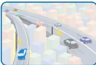
見通しの悪い合流部において、合流してくる車両の存在を合流部の手前で音声により情報提供します。
