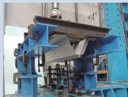
折板ぶき接合部の荷重試験
