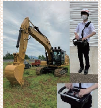
遠隔操作対応建設機械
