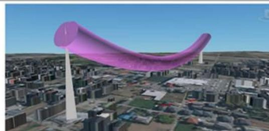
高圧線モデル (入間線 66, 000V) ※離隔距離 4m (半径 4m)
