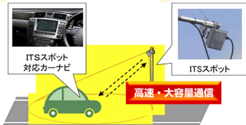
ITSスポットサービスの仕組み
