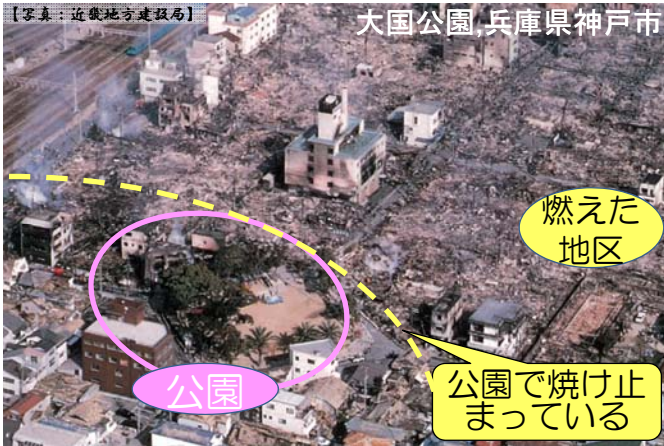
【写真：近畿地方建設局】 大國公園、兵庫県神戸市 阪神・淡路大震災(平成7年)で発生した大規模な火災の焼け止まりとなった公園
