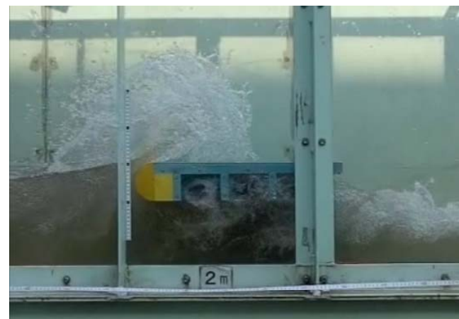
津波によって生じる支承反力に及ぼすフェアリングの設置効果の検証実験
