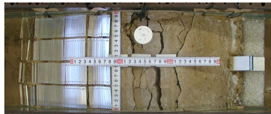
天端沈下0.68m
