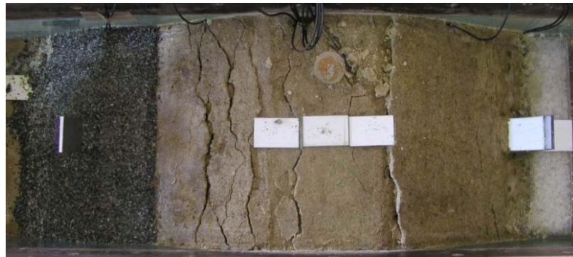
天端沈下0.65m
