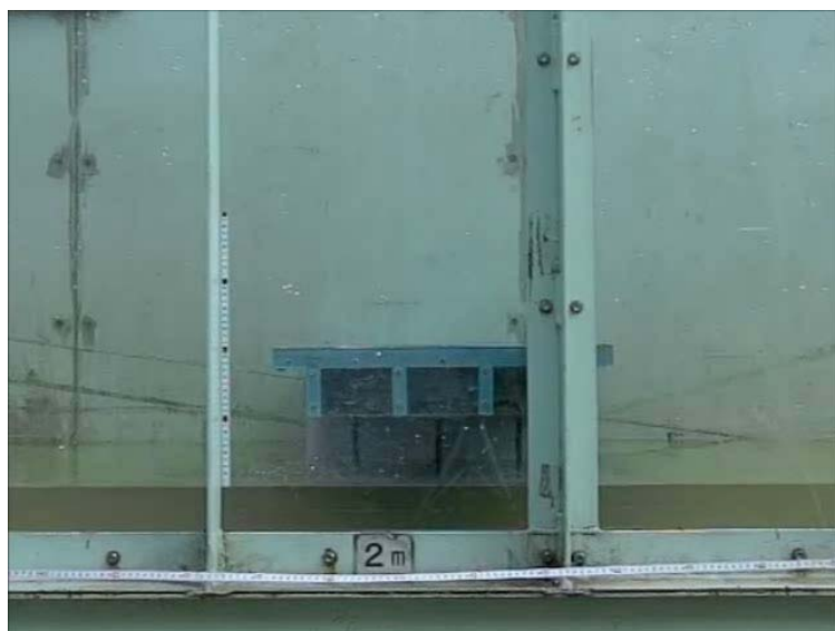
橋桁周辺の流況
