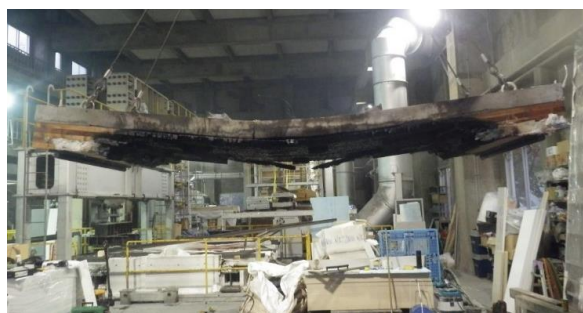
加熱終了後の変形の状況(試験体②: Mu/6・接合金物あり)
