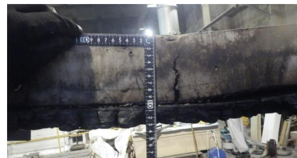
加熱終了後の変形の状況(試験体②: Mu/6・接合金物あり)
