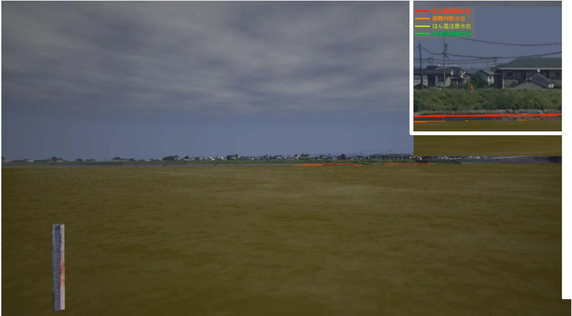
水理計算結果、地形データ、周辺構造物・背景の写真などを合成することにより、**洪水のVR動画**を容易に作成可能
