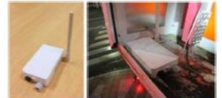
（例）加速度データで落下・倒壊を防止
