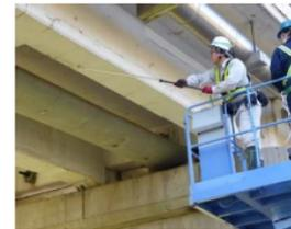
← コンクリートのうき・はく離を非破壊で検査する技術【5技術】
