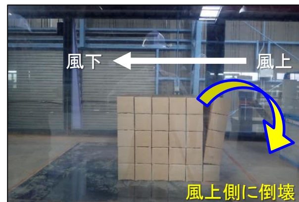
実験の様子(倒壊状況)
