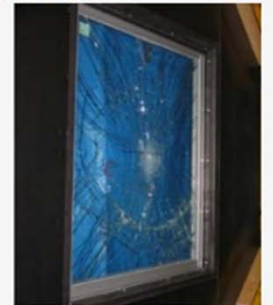
飛来物衝撃試験体
