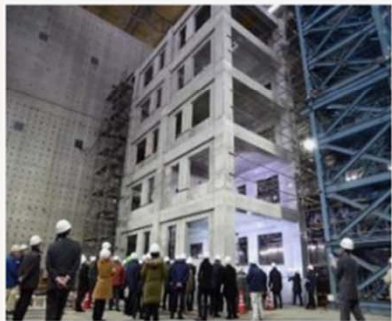
実大5層RC造建築物載荷試験
