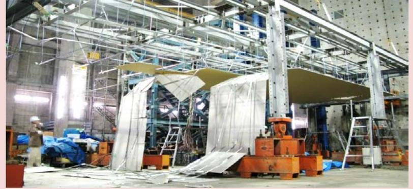
大型天井の動的加振試験
