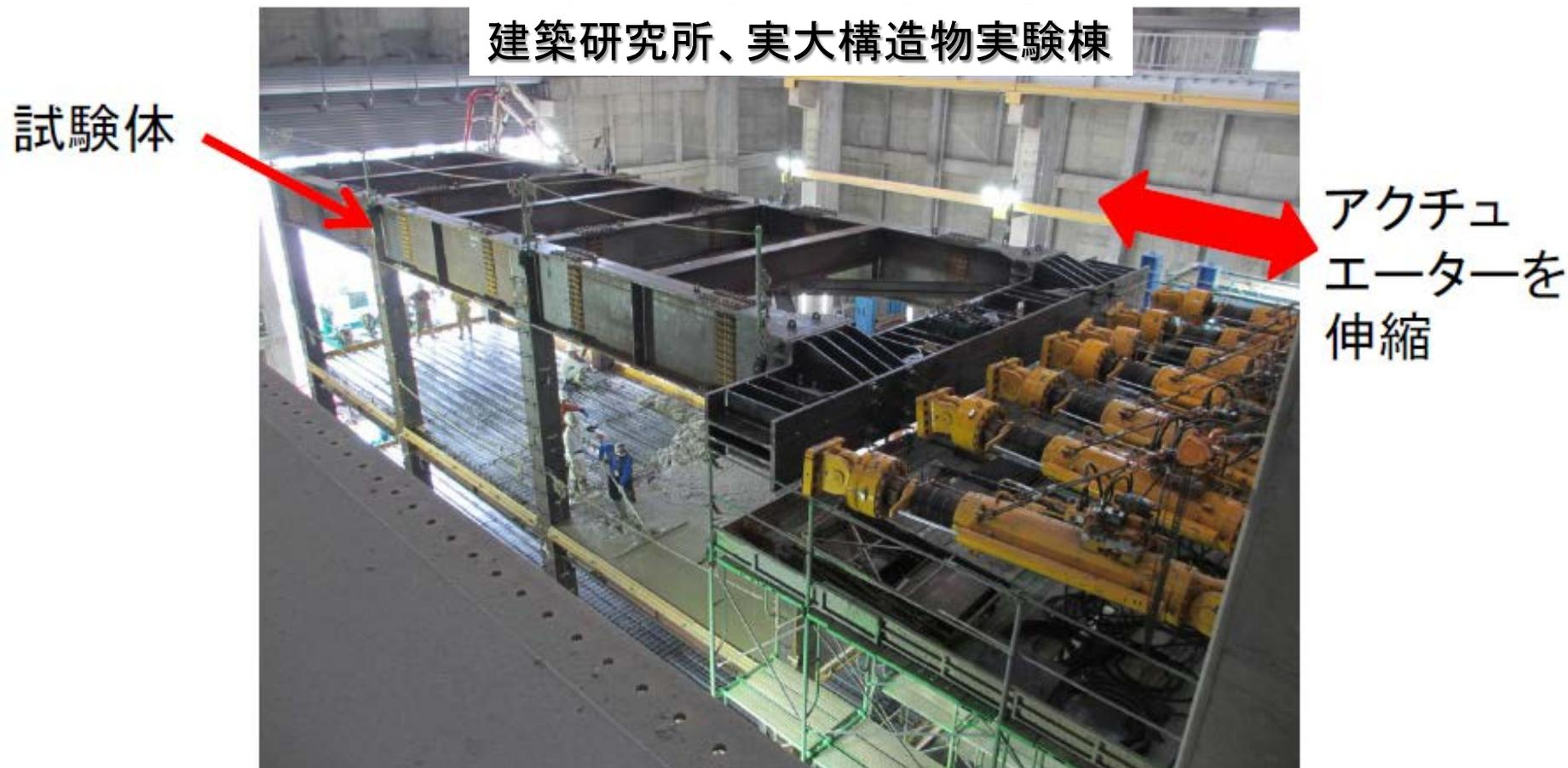
梁端接合部の破断に至るまでの挙動を再現
