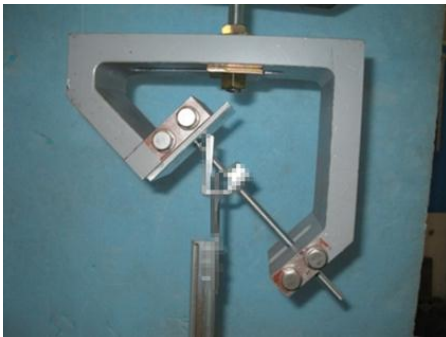
斜め部材の上端接合部の試験体の例
